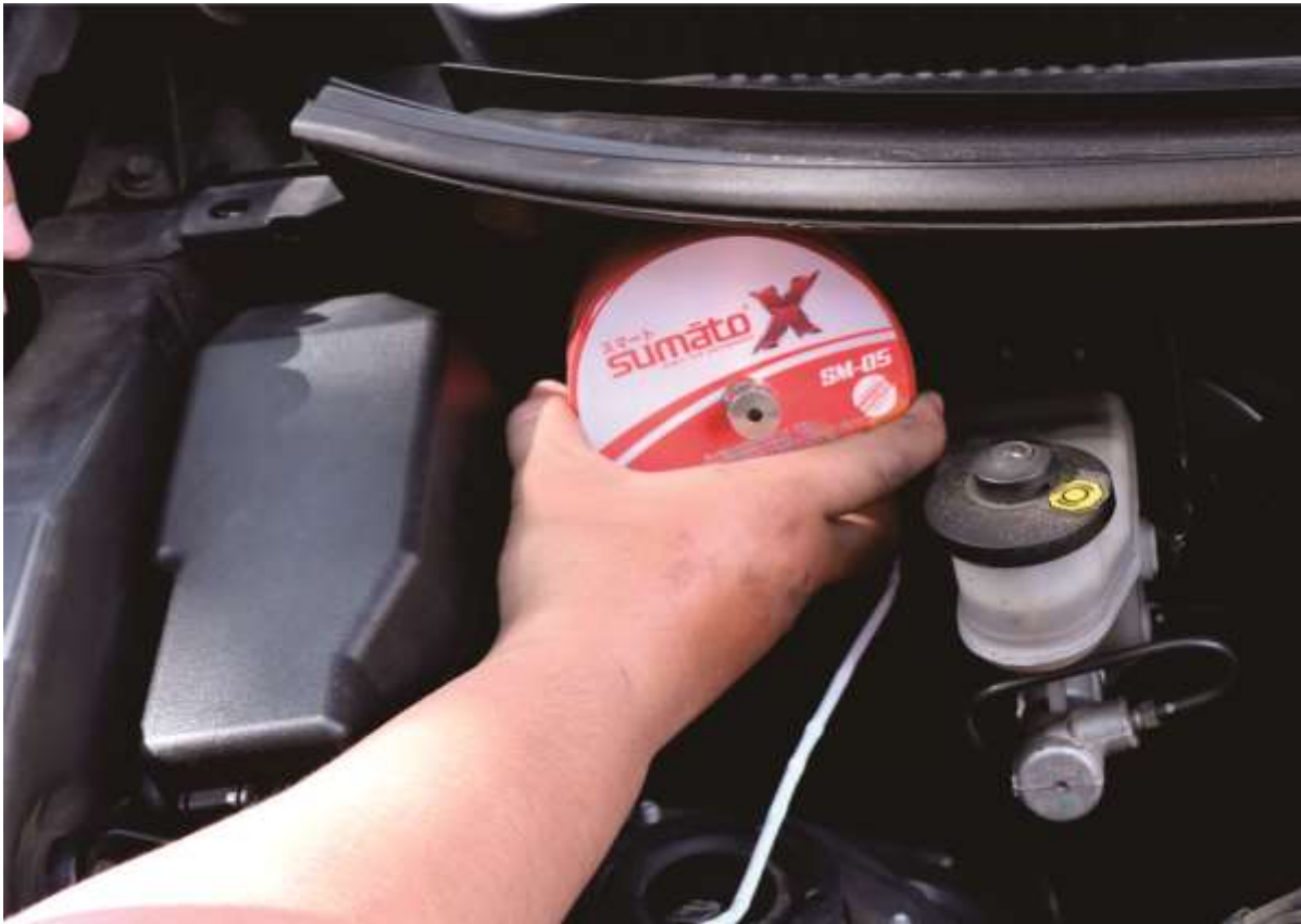
4) Arahkan sumbu detektor lidah api ke aki mobil
